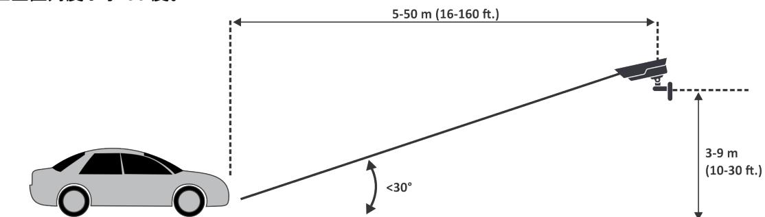
如果在车辆一侧安装摄像头，则摄像头应与牌照处于相同高度，且水平角度小于 15 度。
